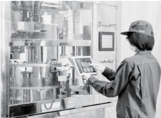
る。一品一様で製作する充填機では操作盤を見ることでしか稼働状況を確認できなかった。遠隔監視は製造フロアの省人化を可能とし、食品工場の衛生対策にも役立つと見る。
